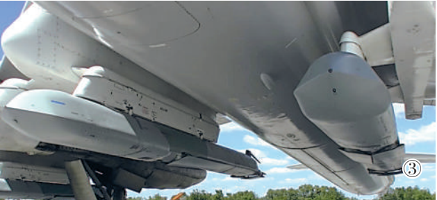
图①:“风暴阴影”巡航导弹渲染图;图②:美国“战斧”BGM-109巡航导弹;图③:俄罗斯Kh-101巡航导弹。
