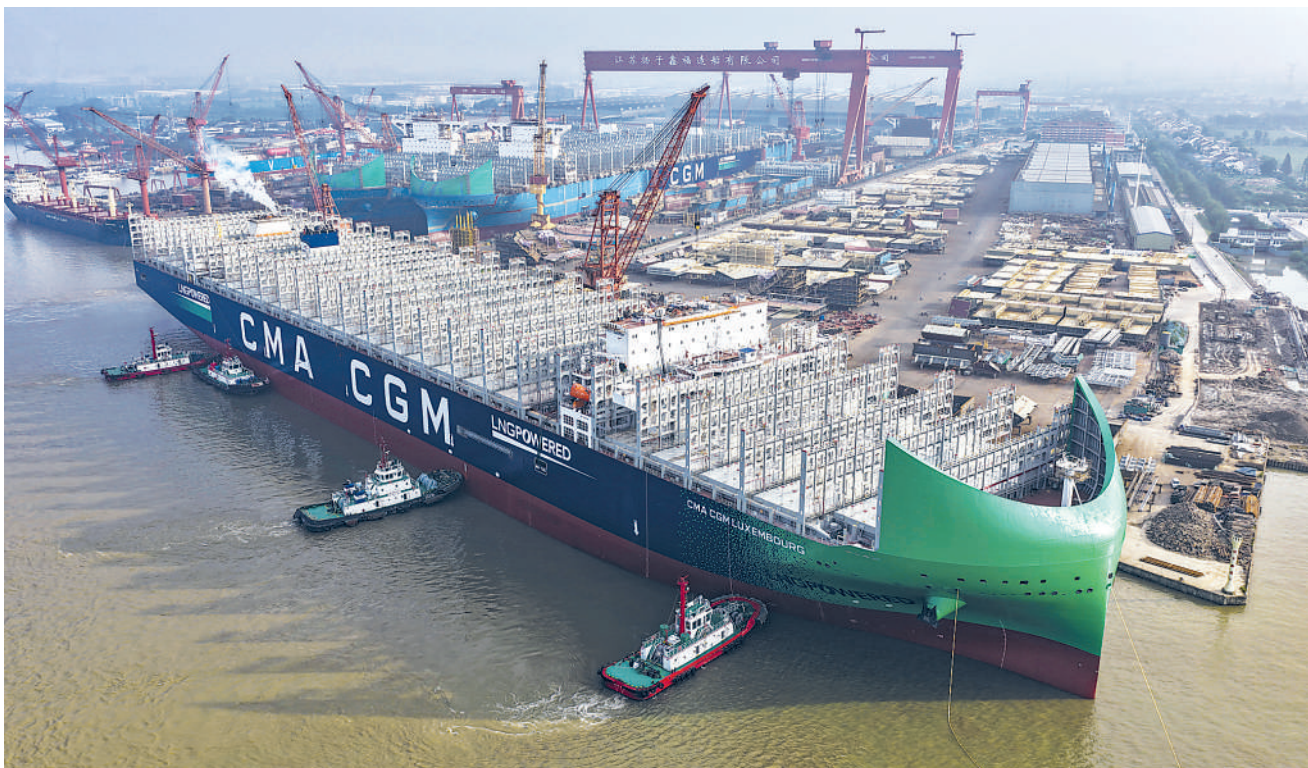
8月18日,由江苏扬子江船业集团建造的24000TEU级超大型双燃料集装箱船“鑫福145”轮,在海事部门全程护航下,从泰兴市江苏扬子鑫福造船船塢码头安全离泊。该轮总长399.9米、型宽61.3米、型深33.5米,是全球超大型绿色环保双燃料集装箱船。图为当日拍摄的“鑫福145”轮停靠江苏扬子鑫福造船船塢码头,开展离泊前各项准备工作。
