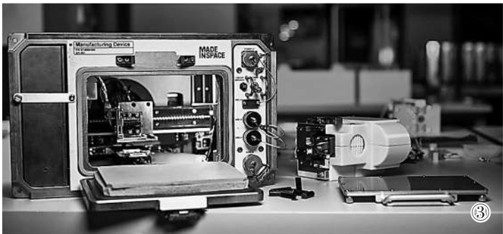
图①:碳纤维材料。 图②:我国无容器材料实验柜。 图③:发射至国际空间站的美国太空3D打印机。
