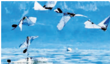
仿生扑翼无人机跨介质飞行(合成图)。
