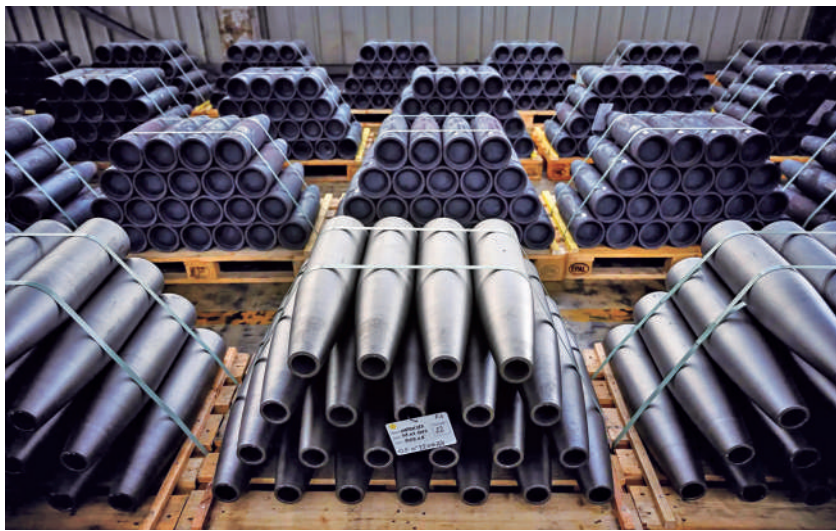
法国塔布锻造厂生产的155毫米炮弹弹体。
