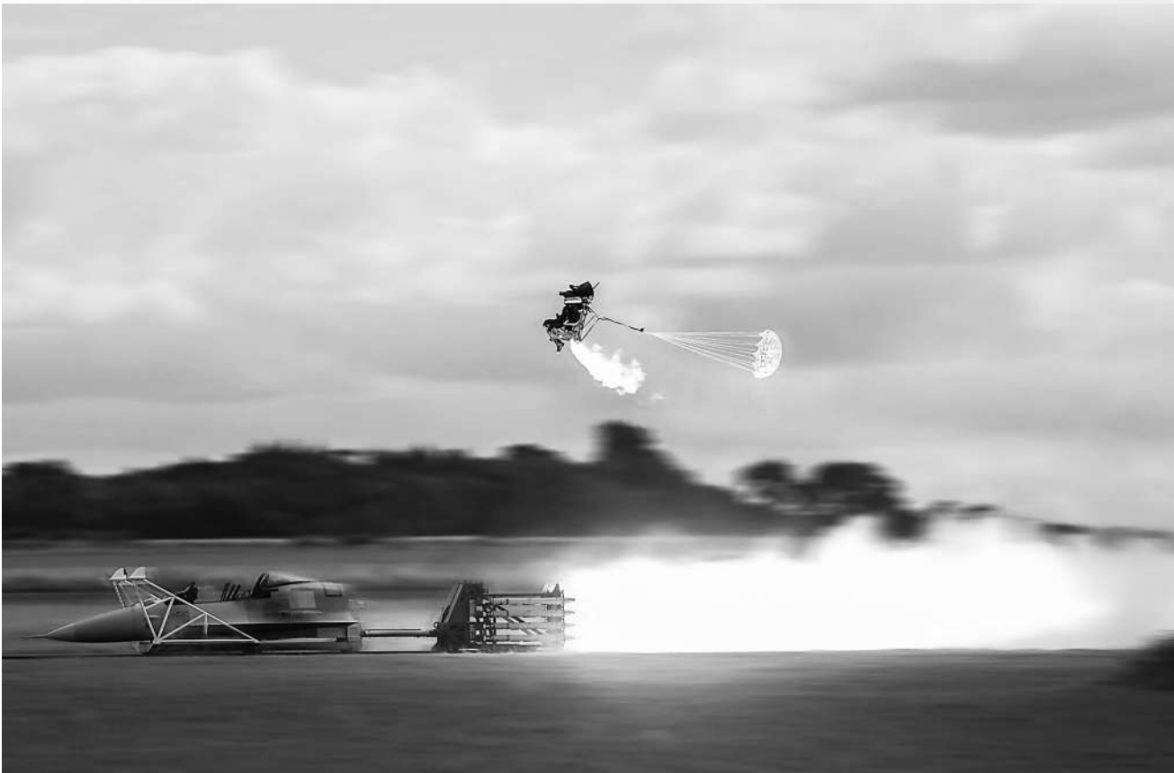
英国马丁·贝克公司 US18E 型弹射座椅进行地面弹射测试。
