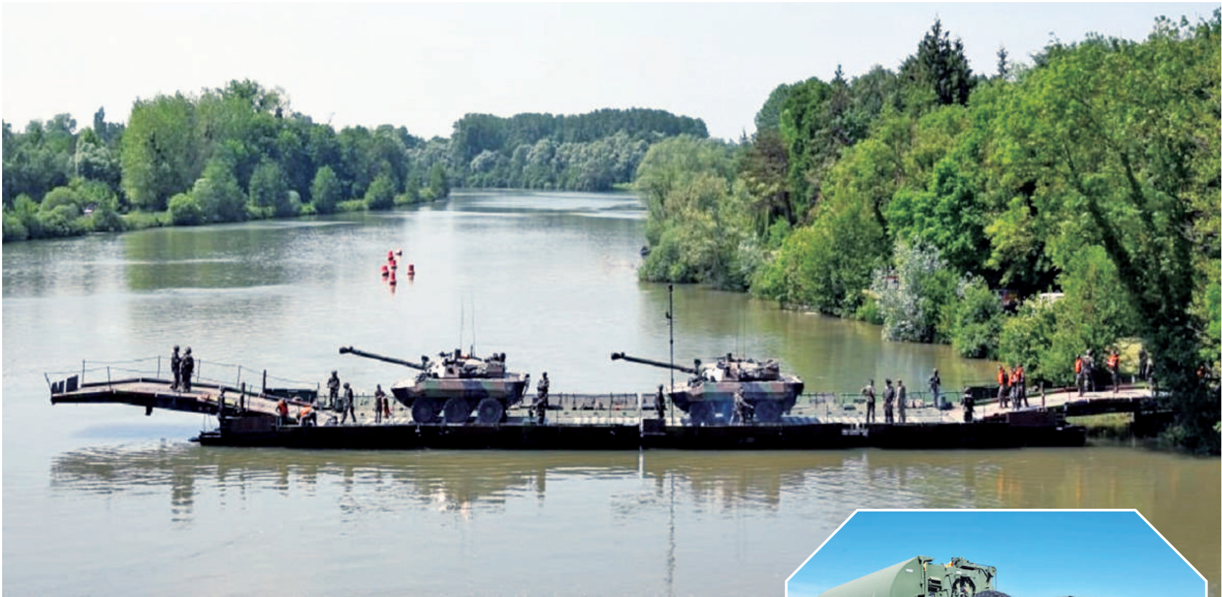
上图：在水面展开后的机动浮桥。
