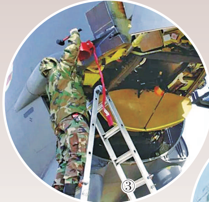
图③:B-52H轰炸机原配AN/APQ-166机械扫描雷达。
