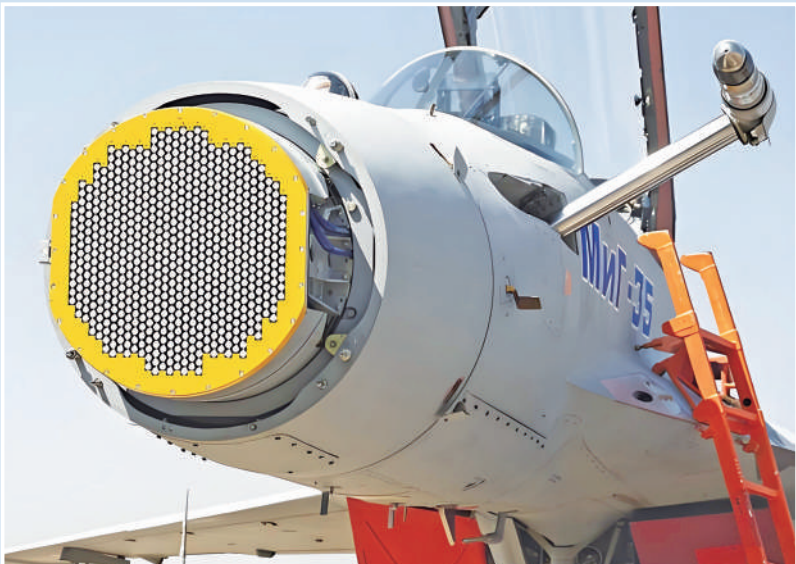
俄罗斯米格-35战斗机的Zhuk-AE机载有源相控阵雷达。
