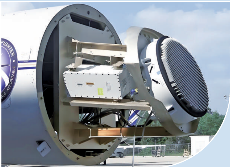
美国F-35战斗机的AN/APG-81机载有源相控阵雷达。
