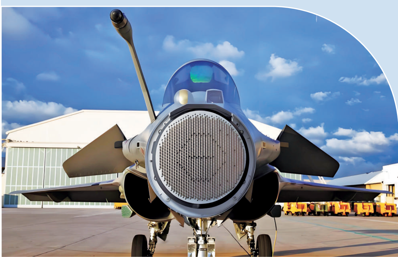
法国“阵风”战斗机的RBE2-AA机载有源相控阵雷达。
