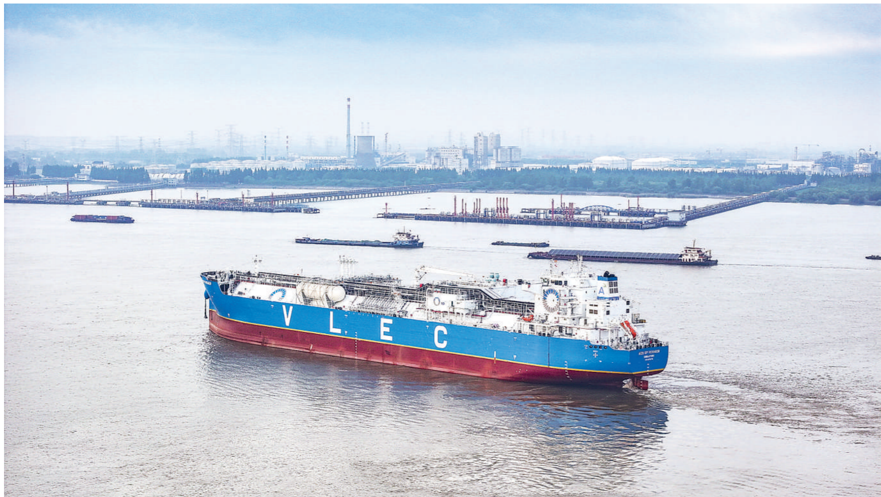
5月8日，超大型乙烷运输船“鑫福137”轮，在泰州海部门全程保障下，于江苏省泰州市泰兴市出江试航。该轮总长229.9米，型宽36.5米，舱容达10万立方米。图为“鑫福137”轮行驶在长江靖江段。
