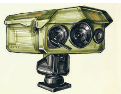
基于“懒猴”雷达开发的雷达光学系统手绘图。
