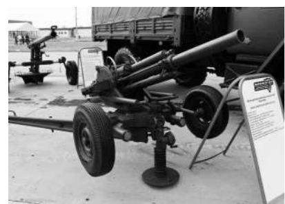
苏联2B9“矢车菊”82毫米自动迫击炮。资料图片
