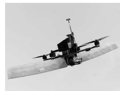
加装了固定机翼的乌克兰四旋翼FPV无人机。
