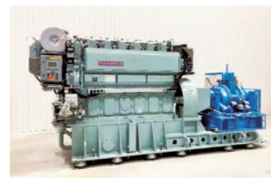
日本公司开发的船用氢燃料发动机。
