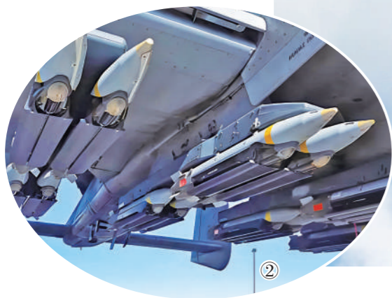
图①:瑞典空军JAS-39“鹰狮”战斗机挂载IRIS-T格斗空空导弹和AIM-120中距空空导弹。
