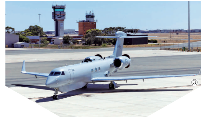
图①:波音737客机改装的E-7“楔尾”预警机。 图②:达索“猎鹰”2000商务机改装的“信天翁”海上巡逻机。 图③:“湾流”G550商务机改装的MC-55A情报、监视和电子侦察机。
