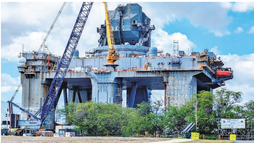
拆掉白色雷达罩的海基X波段雷达SBX-1。
