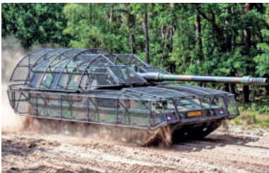
PzH2000NL自行火炮安装“反无人机网”效果图。
