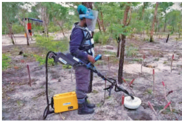
扫雷人员测试新型手持式探雷器。
