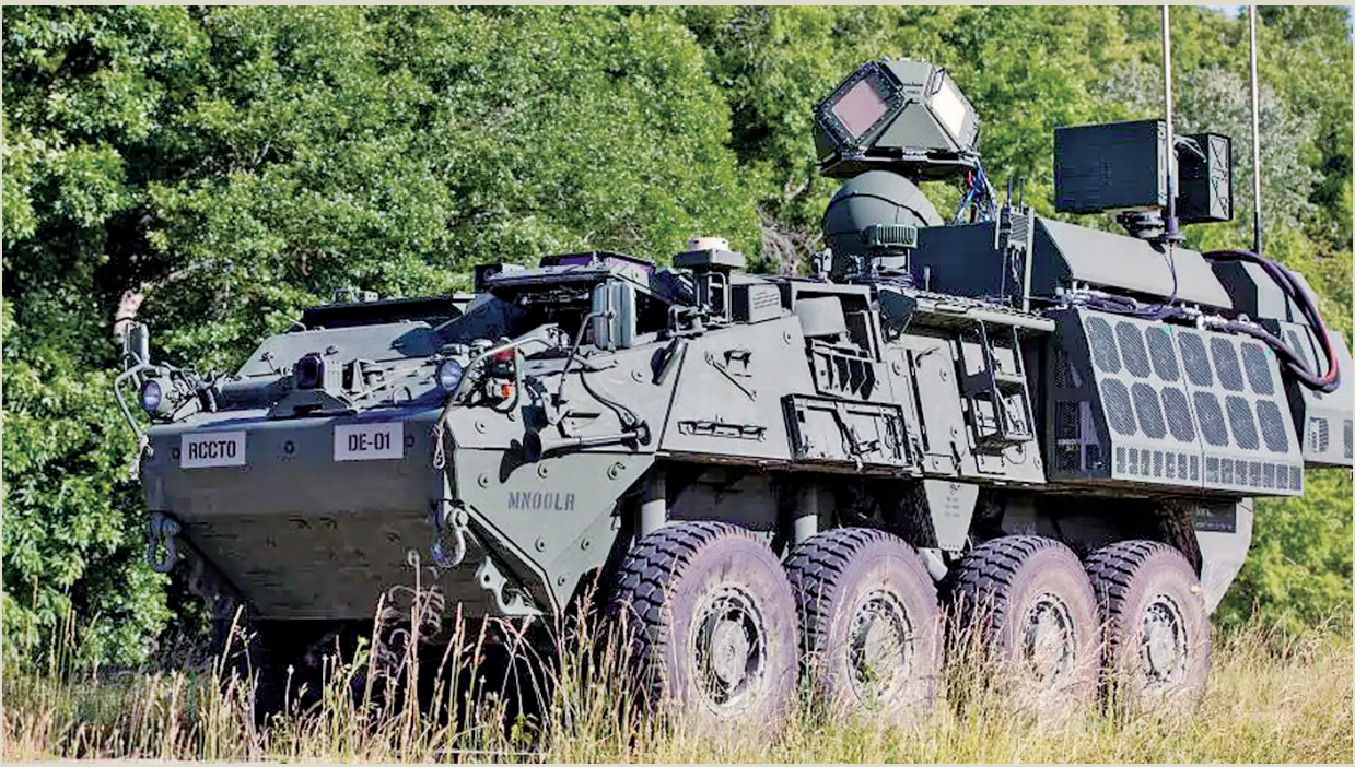
美军“斯特赖克”A1装甲车搭载50千瓦激光武器。
