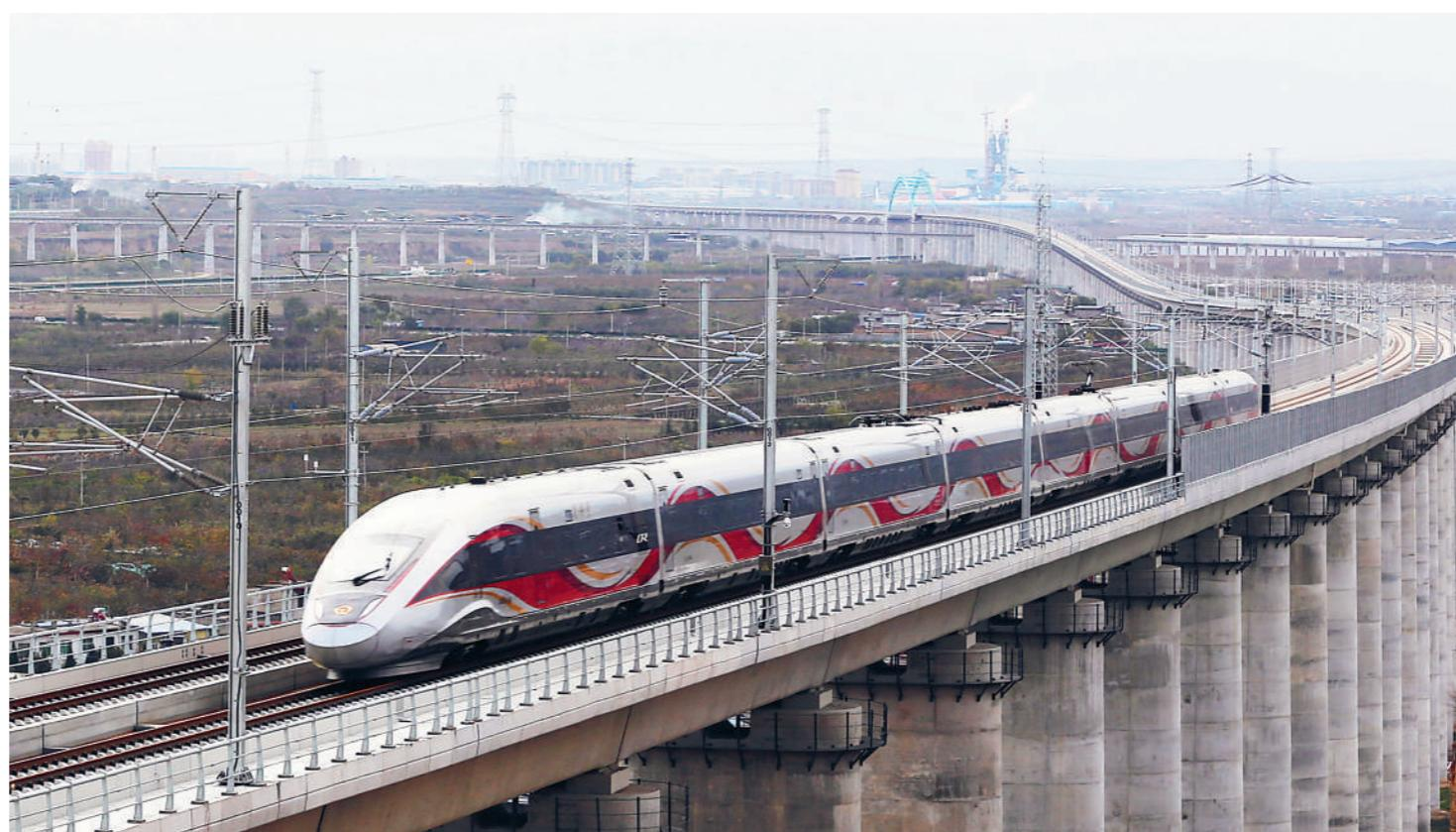
西安至延安高速铁路是陕北革命老区的首条高铁，线路全长299.8公里，设计时速350公里。西延高铁开通后，西安至延安的铁路运行时间将从目前约2.5小时缩短至1小时左右。图为11月17日上午，55302次试验动车组沿着新建西安至延安高速铁路驶向延安站。
