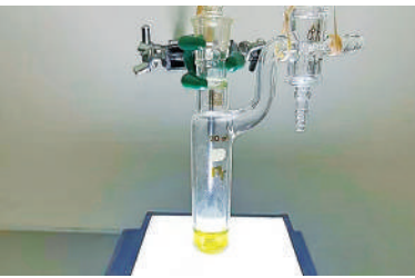
使用氮、水和光线等合成氨的实验装置。
