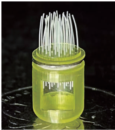
集成不同仿生纤毛阵列的胶囊型声控药物释放装置。
