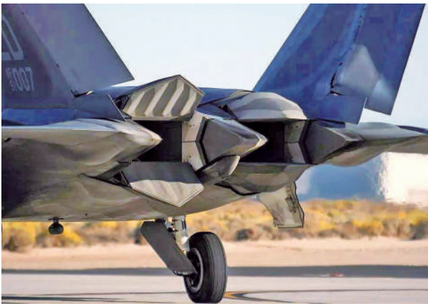
缝隙式尾喷管可迅速降低尾焰温度,减少红外辐射。
