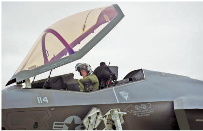
采用吸波涂层的战机座舱盖,能有效减少对可见光的反射。
