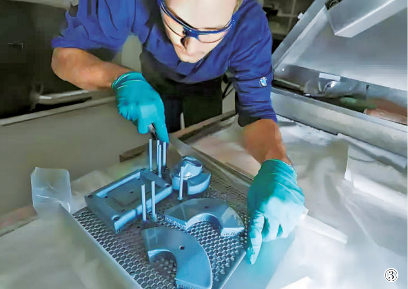
图①:英国陆军用3D打印设备打印一架FPV无人机。
