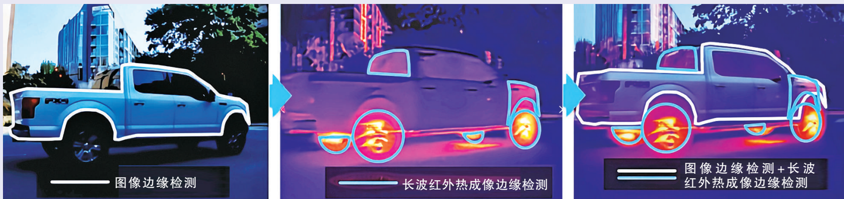
AI 目标定位系统利用图像传感器和长波红外传感器对目标进行分层探测识别示意图。
