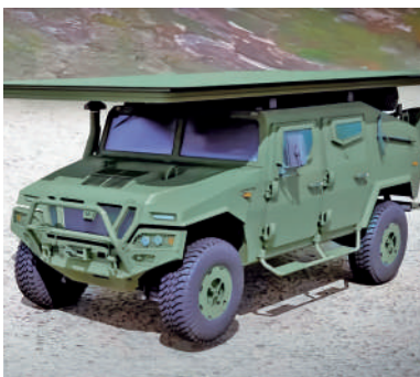
安装“卡利斯托盾牌”伪装系统的装甲车辆。
