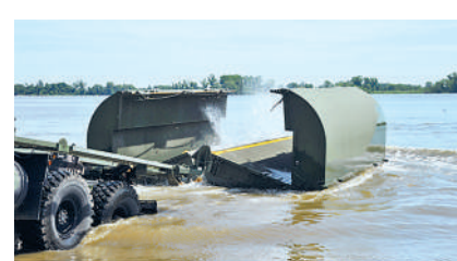
正在水中展开的瑞典改进型带状舟桥系统(IRB)。
