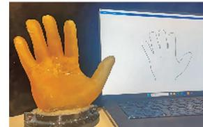
新型皮肤制成的人手状测试模型。
