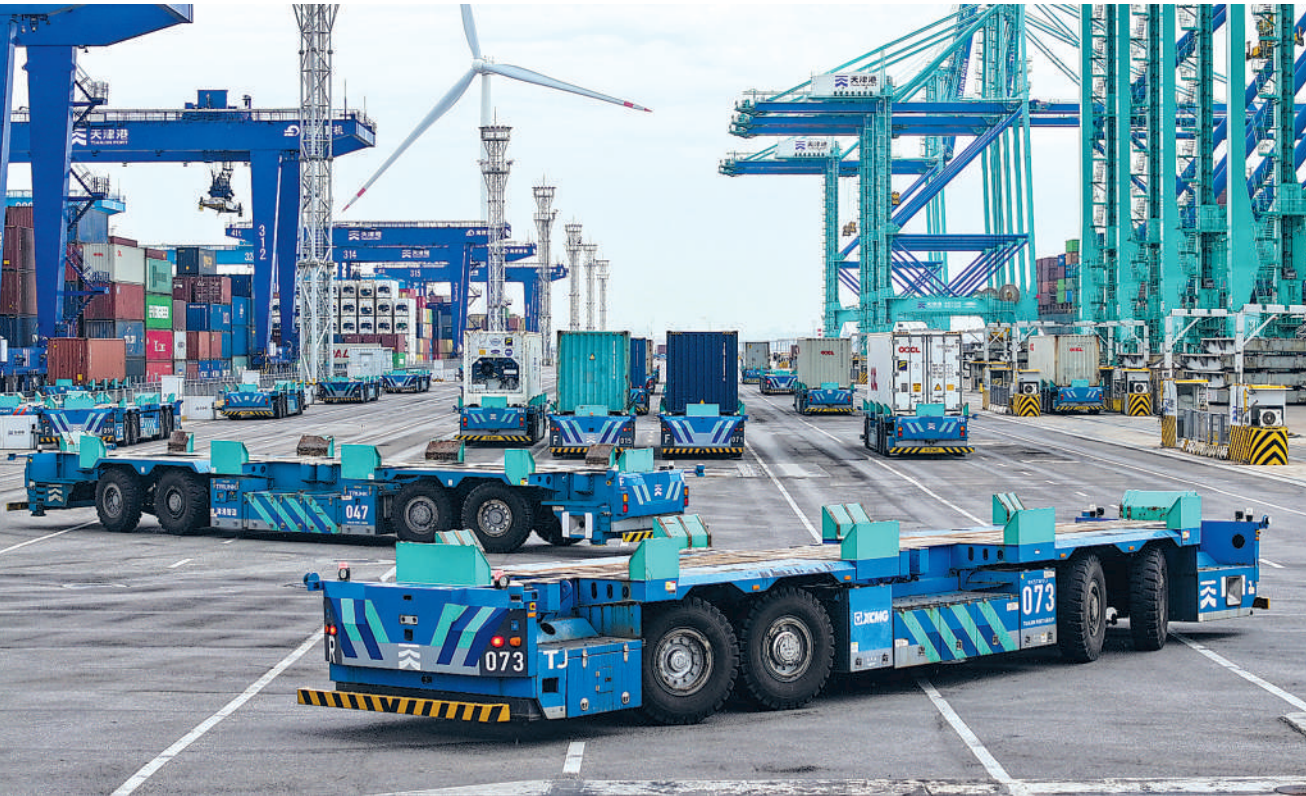
近年来，天津港持续推动传统码头全流程自动化升级。目前，天津港已实现集装箱与干散货码头智能化改造全覆盖，大型集装箱设备自动化率超88%，平均作业效率提升15%。图为6月19日，智能水平运输机器人行驶在天津港第二集装箱码头（无人机照片）。
