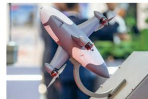
SKYctrl系统是波兰先进防御系统公司研发的综合性反无人机系统。该系统由雷达、声学传感器、光电系统、电子战站等共同构成。近年来,该公司为这套综合性反无人机系统增加了撞击型无人机模块,模块主体就是SKYctrl拦截无人机。
