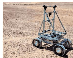
装备Lupin月球导航系统的探测车模型。
