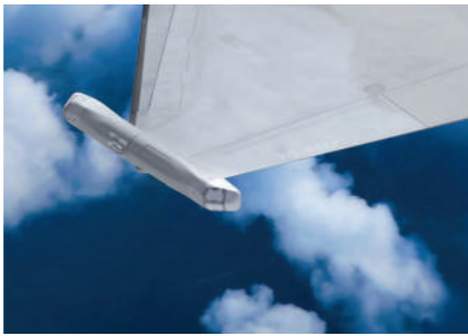
“鹰狮”E战机(右图)及其Aresis电子战系统中的翼尖吊舱(上图)。
