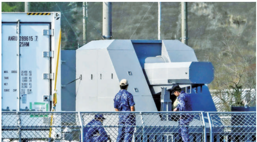
日本海上自卫队“飞鸟”号试验舰上安装的新型电磁轨道炮。
