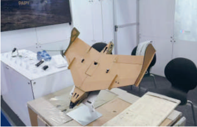
图为韩国 PapyDrone-800 纸板固定翼侦察无人机。资料图片
