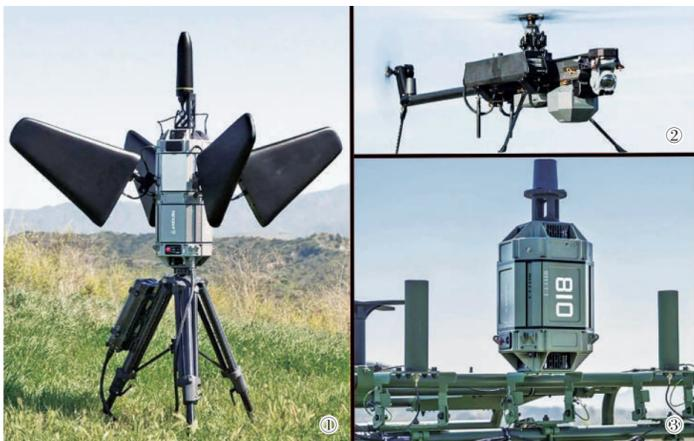
安杜里尔公司的电子战系统可固定配置(图①),也可安装在航空器(图②)和作战车辆(图③)上。
