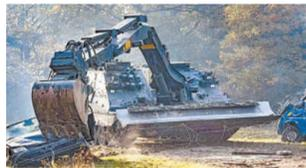
Kodiak装甲工程车是一款履带式装甲车,采用了与“豹2”主战坦克相同的底盘,因此该工程车拥有较好的机动性、防护性和零部件通用性。
