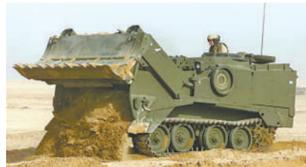
与前两种装甲工程车相比,美军M-9装甲战斗工程车采用了焊接铝合金壳体和螺栓连接的钢架结构,重量较轻,约为16.3吨,能通过空运快速部署。据称,该工程车以前还具有两栖能力。
