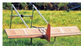
在弹射器上准备发射的CorvoPPDS纸版无人机。
