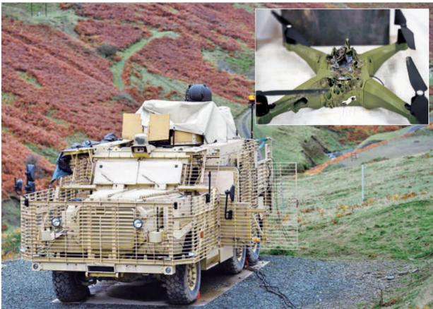
搭载激光武器的“猎狼犬”6×6装甲车。右上小图:被击中后的无人机。
