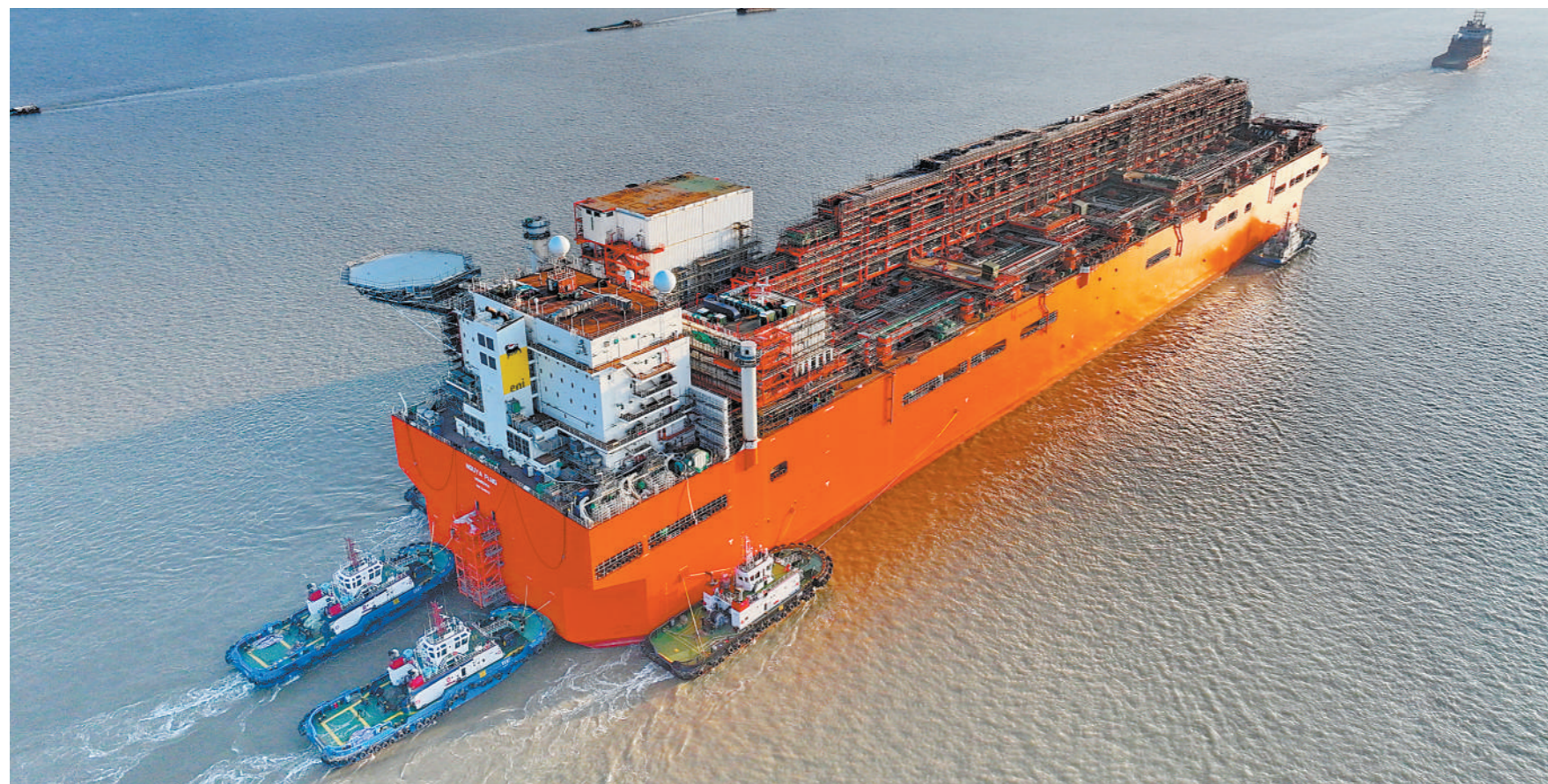
12月9日,我国首座大型浮式天然气液化装置“NGUYA FLNG”轮从江苏南通开发区顺利拖航出江,前往浙江舟山进行上部模块安装、集成和调试。图为当日该轮在拖轮拖带下行驶在长江江苏南通段(无人机照片)。
