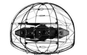
前段时间,瑞士一家机器人公司推出了一款双旋翼室内无人机ASIO。这款无人机采用“笼式结构”桨叶保护罩,拥有较长的续航时间,且更加耐碰撞。
