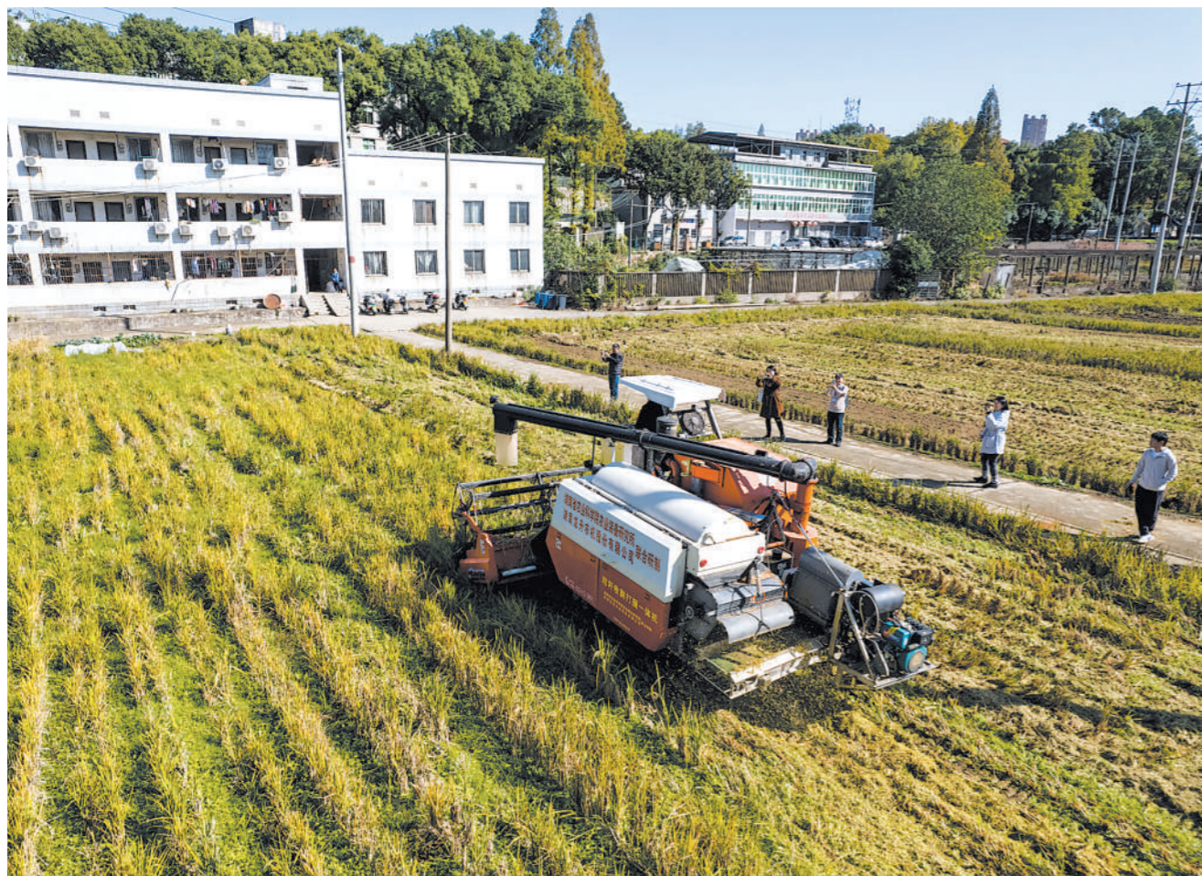
农机在农业大省湖南发挥了重要作用。自2020年起，湖南早稻生产的农机具抛洒面积每年以5%的速度递增。2023年，全省水稻耕种收全程机械化率达83.46%，农业科技创新水平整体位于全国前列。图为11月26日在湖南省农业装备研究所东湖路试验田拍摄的秸秆收割打捆一体机(无人机照片)。
