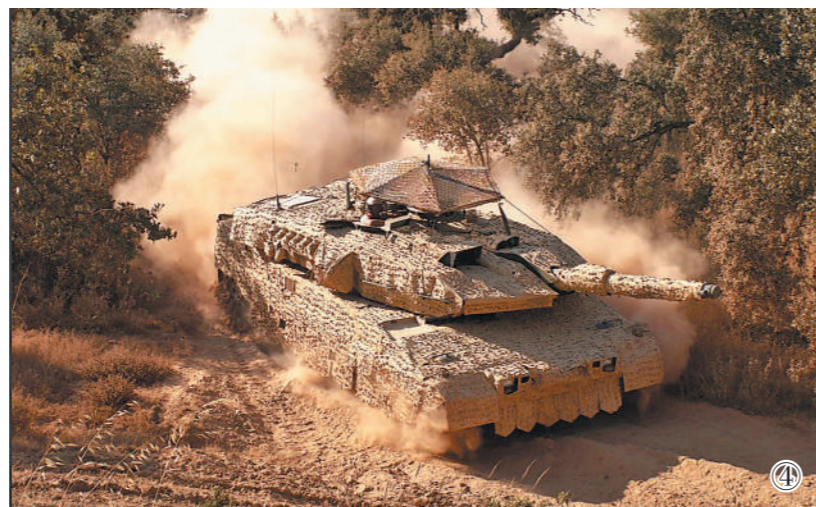
图①:TDM-2K车载气溶胶热烟罩机;图②:Ray Service多光谱伪装网;图③:MALD空射诱饵弹;图④:“梭子鱼”Barracuda多光谱伪装系统。
