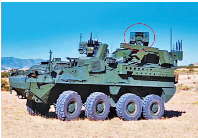
位于车后顶部的26千瓦激光武器(图中红圈内)。
