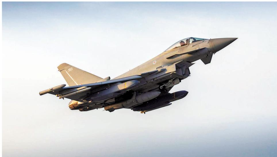
搭载“风暴阴影”空射巡航导弹的英国空军“台风”战斗机。
