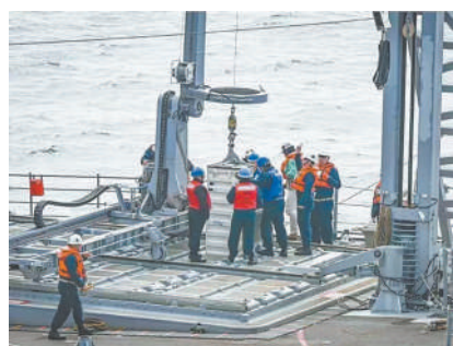
前不久,美国海军使用“转移式装弹系统”进行垂发系统海上装弹测试。
