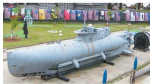
“海豹”袖珍潜艇是二战期间纳粹德国大量制造并投入实战的一种潜艇。该型潜艇艇长11米多,满载排水量15吨,由两名艇员操纵。
