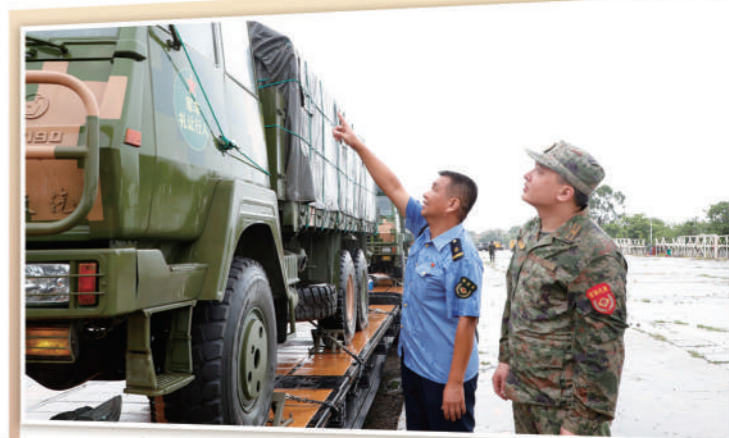
黎应雄（左）和王邵龙在工作中既是师徒又是搭档。图为一同检查铁路运输装备捆绑加固情况。李向平摄
