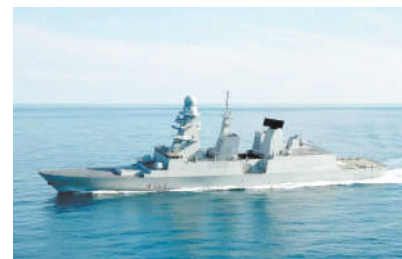
采用了一体化桅杆设计的意大利海军地平线级驱逐舰。资料图片
