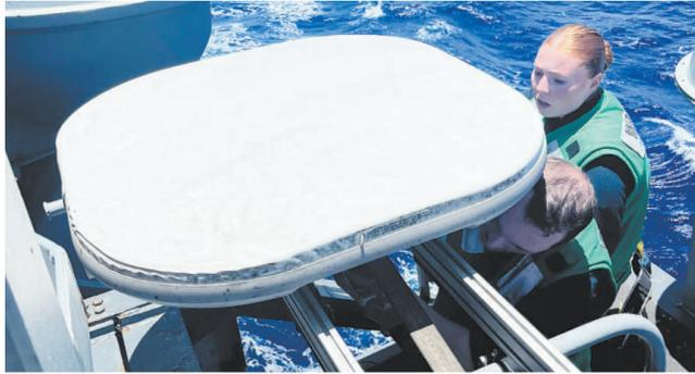
美军在“林肯”号航母上安装 Kymeta 平板卫星天线,该天线已接入“星链”系统。
