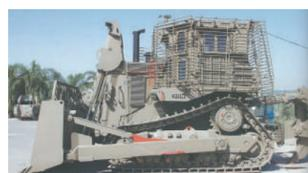
D9R装甲推土机是以色列军队列装的一型工程机械,在民用履带推土机基础上改装而成,有着较好的性能和可靠性。为适应实战尤其是巷战要求,以军加强了它的防护能力。
